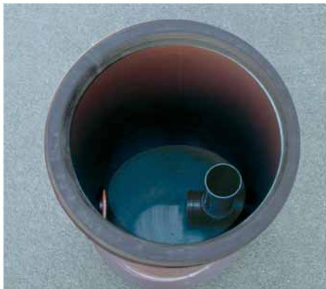
Дроссельный колодец HS® DN/OD 800 устанавливается тогда, когда сточную ливневую воду следует направлять в общеславную канализационную сеть более медленным потоком. Например, после очистки дождевых вод или в зоне их инфильтрации.
