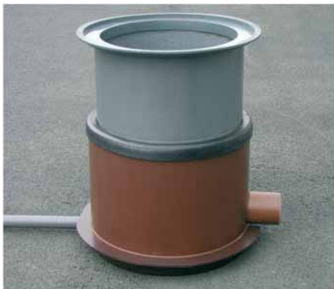
Компенсирующий колодец HS® отвечает требованиям расчетной рабочей таблицы ATV-DVWK A 157. В самых высоких точках он несёт функцию приточно-вытяжной вентиляции и на самых низких участках служит для опорожнения напорного трубопровода сточных вод. Интегрированный фитинг позволяет осуществлять стыковку с напорным трубопроводом размером до DN/OD 160. Также возможно подключение безнапорных (самотечных) трубопроводов размером до DN/OD 200.
