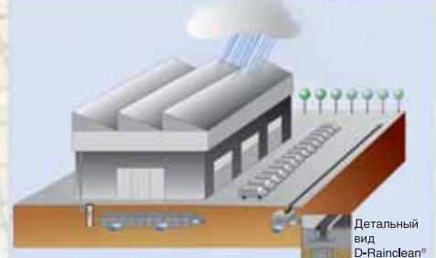
Вариант подземной укладки ливневой канализации с последующей инфильтрацией, а также с возможным водоотведением ливневых сточных вод с парковок автотранспорта, где с целью очистки загрязненных вод устанавливается в сочетании с D-Rainclean®, сертифицированного соответственно НРБ-99, ГН 2.1.1338-03 З ПДК.
