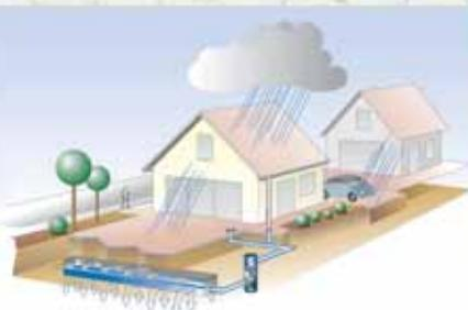
Система инфильтрации дождевых вод, уложенные в ряд резервуары D-Raintank®, оснащена подключенным очистным колодцем диаметром 315мм.
