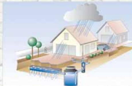
Система инфильтрации дождевых вод, уложенные в ряд резервуары D-Raintank®, служит в качестве перелива воды из подземной ёмкости для возможного дальнейшего использования (полив).
