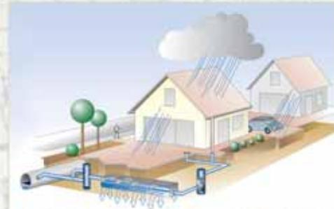
Система инфильтрации дождевых вод, уложенные в ряд резервуары D-Raintank®, оснащена подключенным очистным и подсоединенными дроссельным колодцем диаметром 315 мм.
